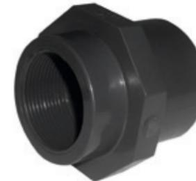
Übergangsstück von Klebemuffe/ Stutzen auf ein Außengewinde. Format 50/63 mm bedeutet, dass man auf dieser Seite einen Schlauch 50 mm einkleben oder eine Muffe mit da 63 darüberkleben kann.
