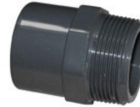
Übergangsstück von Klebemuffe/ Stutzen auf ein Außengewinde. Format 50/63 mm bedeutet, dass man auf dieser Seite einen Schlauch 50 mm einkleben oder eine Muffe mit 63 mm darüberkleben kann.
