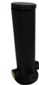
**Verteilerschacht Ecu-Drän 25.10** mit Deckel und Anstaurohr zur Rückflussverhinderung. Inkl. Vliesmantel zur Vermeidung eines Strömungskurzschlusses. Inkl. Anstaurohr, 1 Eingang 100/63 mm, 2 Verteileranschlüsse DN 100 Steckmuffe
