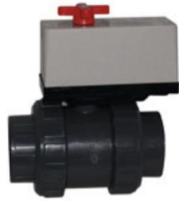
Motorische Kugelhähne für das automatische Öffnen und Schließen einer Leitung können z. B. zum zeitweiligen Betrieb von Wasserspielen oder Bachläufen gut eingesetzt werden. Schutzart IP54. Teilschließung nur mit Steuerkasten (Art. 82159) möglich!
