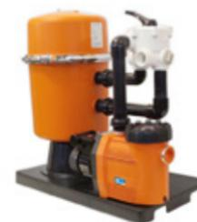
**NEU** Sandfilteranlagen mit Filterkessel aus glasfaserverstärktem Niederdruck Polypropylen. Mit 5+1-Wege Rückspülventil, Manometer, automatischer und manueller Entlüftung und Kesselentleerung. Auf Palette montiert und mit D & W Silent Pumpe vormontiert. Die Pumpe ist selbstansaugend und mit Kabel inkl. Schukostecker ausgestattet.
