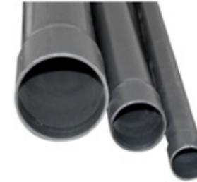
Die grauen Druckrohre aus PVC mit der Druckfestigkeit PN 10, auf Bestellung auch PN 16, werden zum Leitungsbau im Schwimmteich verwendet und können mit PVC-Fittings verklebt werden. Die Standardlänge einer Rohrleitung beträgt 5 m.
