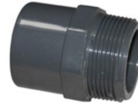
Übergangsstück von Klebemuffe/ Stutzen auf ein Außengewinde. Format 50/63 mm bedeutet, dass man auf dieser Seite einen Schlauch 50 mm einkleben oder eine Muffe mit 63 mm darüberkleben kann.
