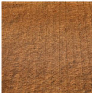
**Erosionsschutzmatte Typ VI (Holzfaser)**
