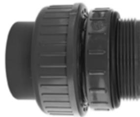
Verschraubungen sind in drei Versionen erhältlich: beidseitig mit Klebemuffe, Klebemuffe und Innengewinde (AG) oder mit Klebemuffe und Außengewinde (inkl. O-Ring). Verschraubungen kommen dort zum Einsatz, wo Leitungen kurzfristig trennbar sein sollen. Dies ist besonders vor und hinter Pumpen der Fall, die zu Wartungszwecken etc. problemlos aus dem System entnehmbar sein sollen.
