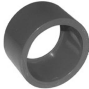
Verkleinert den Durchmesser von Muffen, Beispiel: Eine Reduktion 63/25 mm wird in eine Doppel-muffe 63 mm geklebt und verringert den Durchmesser von 63 mm auf 25 mm.
